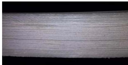
玻璃纤维增强塑料夹砂管（连续缠绕工艺）截面图
